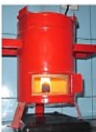
त्यस पछि चुलोको बिचको भागमा ब्रिकेटको तल/मुनी राखी छोड्ने। Place the ignited tablet below center of briquette
